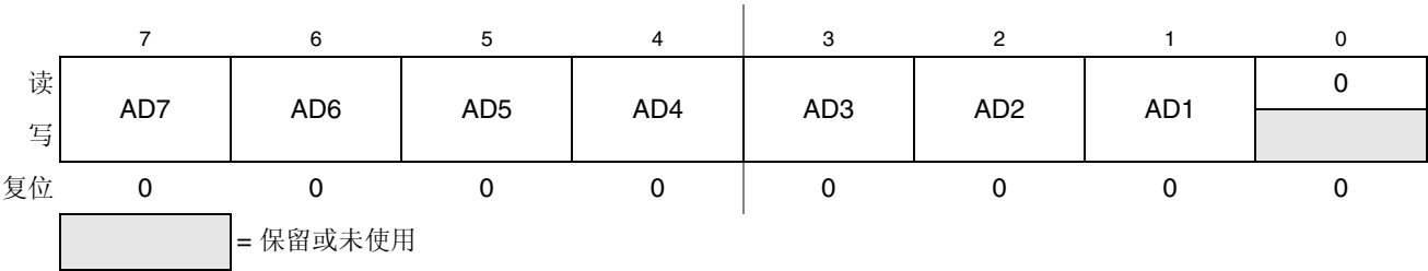
图 13-3. IIC 地址寄存器（IICA）
