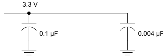
图 9-2. 建议的 M-LVDS 旁路电容器布局
